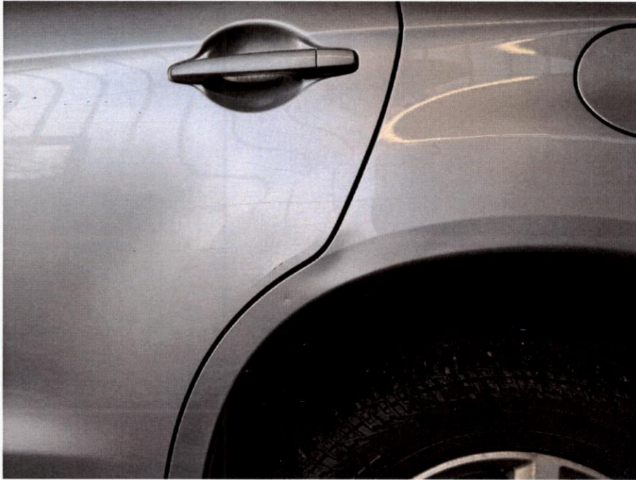
Bild 21: Hintertür und Seitenwand links eingedrückt
