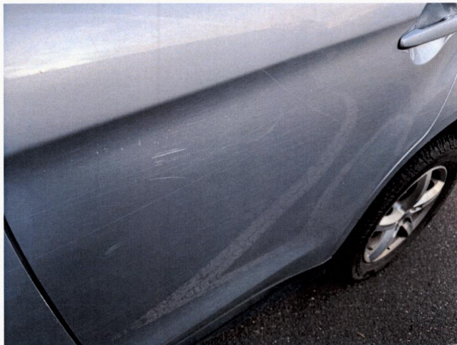
Bild 14: Lackierung Fahrzeugseite links beschädigt
