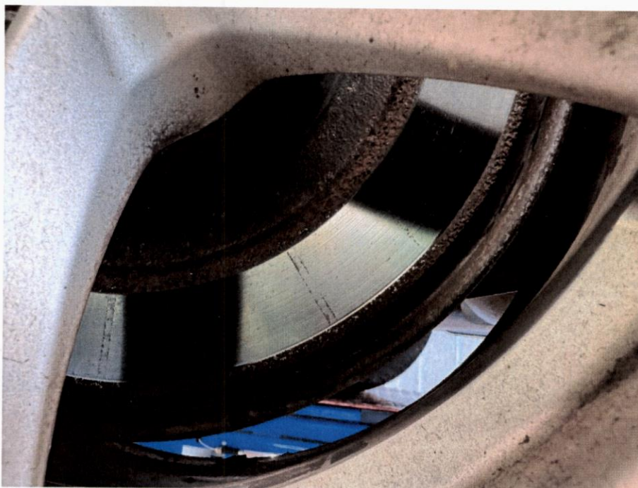
Bild 25: Bremsscheiben hinten Korrosion
